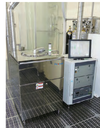
原子層堆積装置 (ピコサン製 SUNALE) Atomic Layer deposition system (Picosun, SUNALE-R150)
