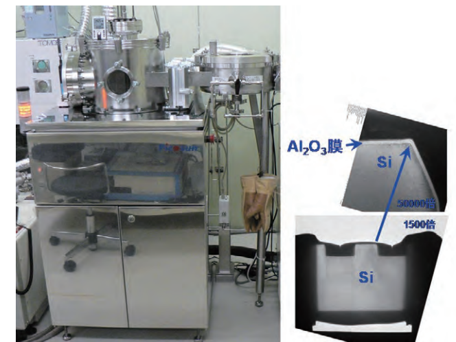
単原子層堆積装置および被覆試料の断面像
