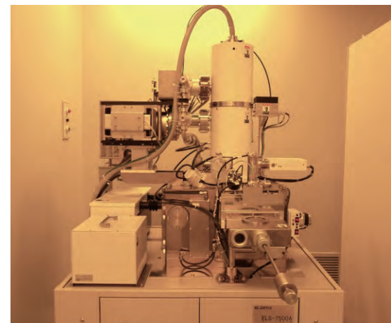
電子線描画装置(加速電圧:50 kV)
