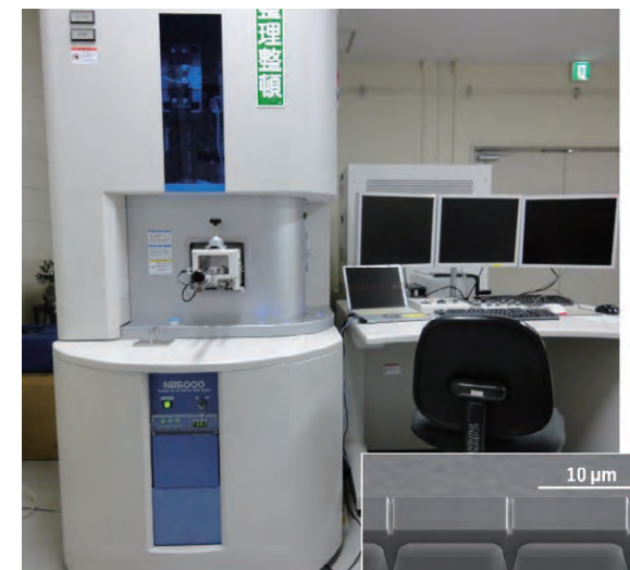
FIB-SEM装置および作製した流体デバイスの溝
