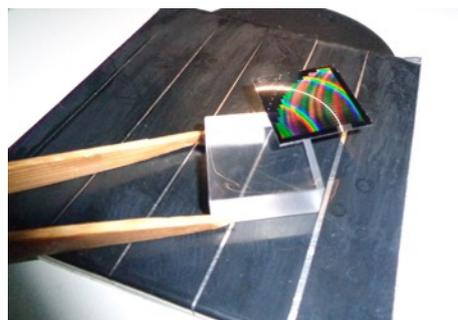
図2 シリコン鋳型と石英基板の接着。
