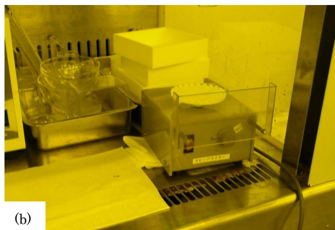
Fig. 1: (a)洗浄ドラフト、(b)現像ドラフト横で利用している小サイズ基板用スピンドライ機器
