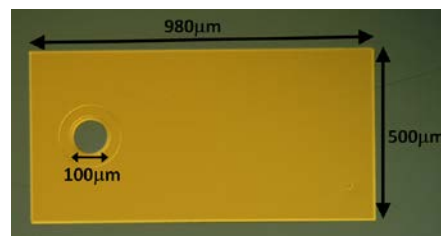
図 1 リング状電極 Mg_2Si フォトダイオード
