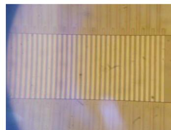
図 2 アモルファスカーボンくし型電極のくし部分拡大像
