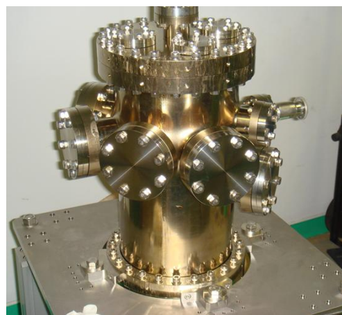
図1 真空封止性能試験に用いたチタン製真空チャンバ。
