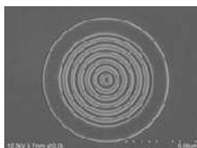
図 1 プラズモンアンテナ型 SERS センサ
