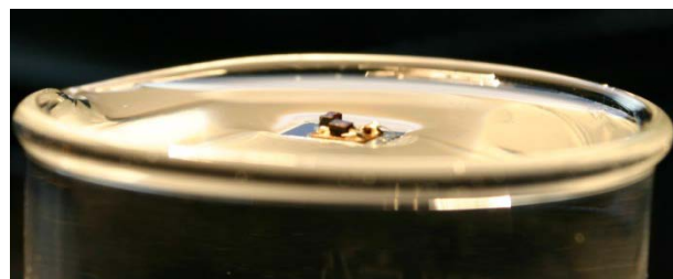
図 無線電送による EWOD 水上走行素子 [1]
