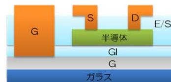
図 1. 試作したトランジスタ素子構成
