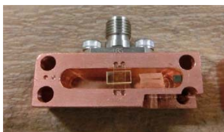
図 1. 銅製マイクロ波空洞共振器と YIG 結晶 (共振 器中右端の黒い立方体)。共振器中にサファイア基板 (計 25 枚) を入れることで共鳴周波数を調整してい る。
