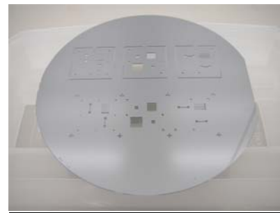
図 1 作製した 4 インチシリコンステンシルマスク
