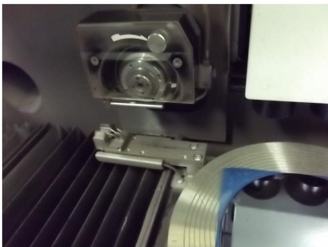
ブレードダイサーによるダイシングの様子
