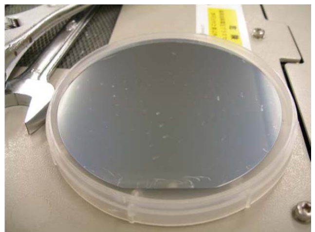
図 PECVD 後サンプル表面の白濁部
