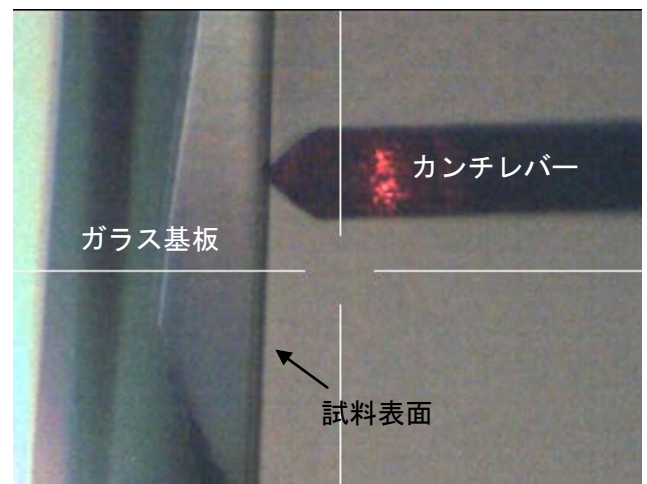
図 1 化合物半導体薄膜太陽電池試料にカンチレバーを近づけた光学写真
