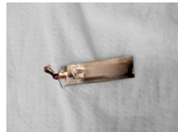
図 1 : イオンコータによることによって Au 薄膜がコーティングされた Nafion 膜
