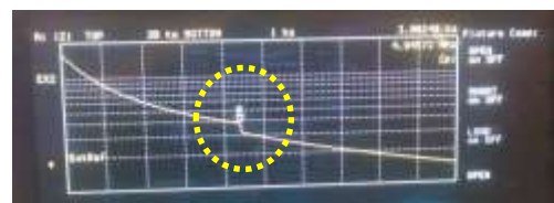
図2 インピーダンスアナライザ測定画面
