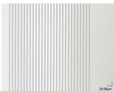
図. レーザー直接描画装置と NLD を用いて作製したサンプル表面の光学顕微鏡写真
