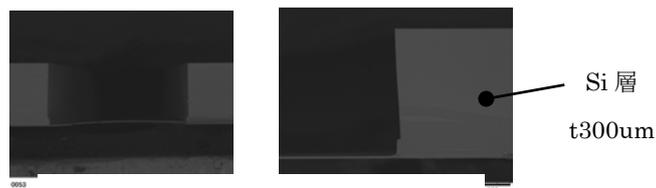
図 2 Si 深堀りエッチングの断面
